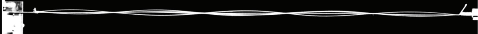
Prin reglarea potrivită a tensiunii din fir și a frecvenței generatorului obținem o undă staționară cu **cinci ventre**
