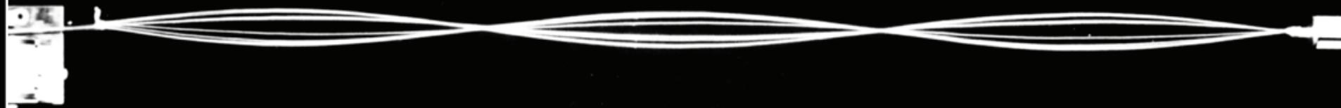
Prin reglarea potrivită a tensiunii din fir și a frecvenței generatorului obținem o undă staționară cu **trei ventre**
