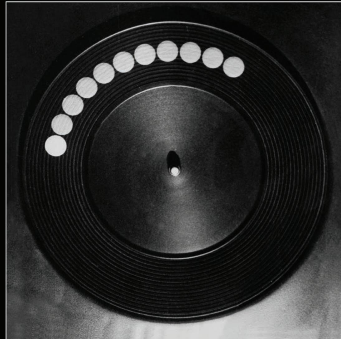
O aspirină pe platanul unui pick-up (RPM = 16;  $\Delta t = 110$  ms)
