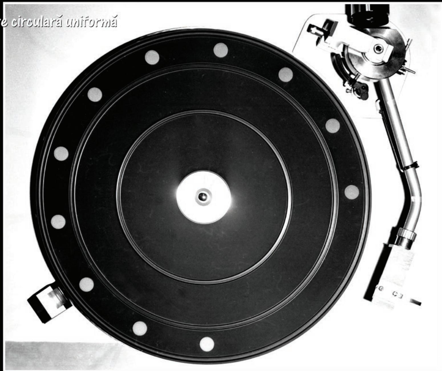
Pe platoul unui pick-up am pus o aspirină. Fotografierea stroboscopică este declanșată de o barieră de lumină ( $n = 45$  RPM; 11 flășuri;  $\Delta t = 100$  ms)
